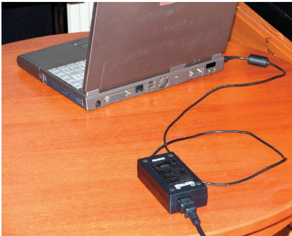
Das Netzteil eines Notebooks mit möglichst großem Abstand zum Benutzer z.B. hinter dem Gerät positionieren.
